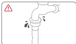
Verbinden Sie die Maschine mit dem Wasserhahn mit einem neuen Wassereinlass-Schlauch und ersetzen Sie den Schlauch rechtzeitig im Falle von Schäden oder Leckage.
