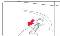
2. Ziehen Sie die Schrauben heraus und bewahren Sie sie ordnungsgemäß auf (zur Verwendung während des Transports).
