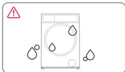
Halten Sie die Maschine fern von Regen oder starker Luftfeuchtigkeit. Verwenden Sie sie bei Temperaturen zwischen 0 und 40 °C.
