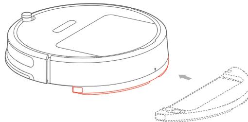
Nota: per ottenere un migliore effetto pulente, si consiglia di installare il modulo per il lavaggio con acqua dopo aver effettuato 3 cicli di pulizia
