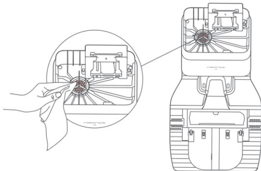
4. Instale una nueva bolsa de polvo en el lugar a lo largo de la ranura y coloque nuevamente la cubierta del contenedor de polvo.
