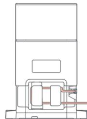
4. Coloque la base sobre una superficie plana y dura (madera/baldosa/hormigón, etc.). Deje al menos 0,5 m (1,6 pies) de espacio libre a cada lado, 1,5 m (4,9 pies) en la parte delantera y 1 m (3,3 pies) encima. Verifique que la ubicación tenga buena conexión WiFi y luego enchúfela.
