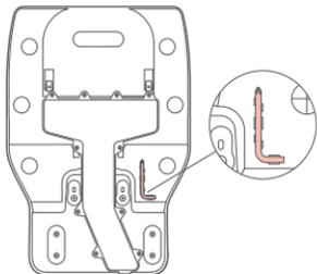
2. Coloque la base boca abajo sobre una superficie suave y plana (alfombra/toalla/paño) y coloque la base usando los seis tornillos proporcionados.
