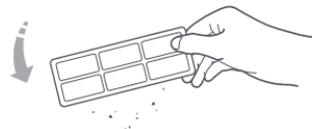
5. Lasciar asciugare il filtro prima di reinstallarlo.
