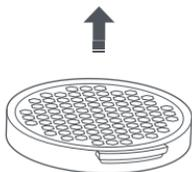
2. 將濾網放入氣旋組件偏右側位置，並向左輕推，將氣旋組件上的防濾網漏裝卡扣推入卡槽，並使濾網上的突出部分嵌入氣旋元件頂部的缺口中。
