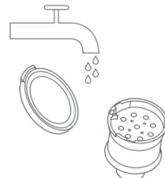
5. Просушите передний фильтр и мультициклонную систему в течение 24 часов.
