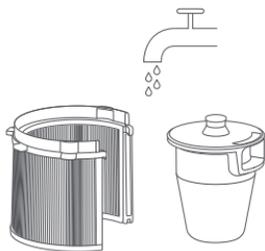
4. Scuotere eventuale acqua rimanente e lasciare il filtro ad asciugare per 24 ore o fino a che sarà completamente asciutto.
