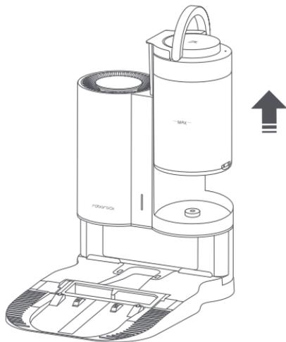
2. Posizionare il cestino della polvere sopra un contenitore, a circa 15 cm (6 pollici), poi premere il dispositivo di apertura del cestino della polvere.
