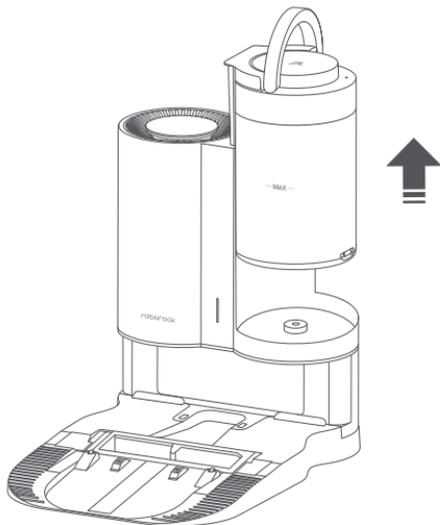
2. Premere il dispositivo di apertura del cestino della polvere per aprire il coperchio inferiore del cestino.
