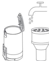
3. Lasciare il cestino della polvere e il separatore a ciclone ad asciugare per 24 ore o fino a completa asciugatura.
