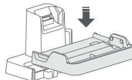
2. Connectez l'alimentation électrique au bas de la station de recharge et branchez-la. Le câble d'alimentation peut sortir par le côté.
