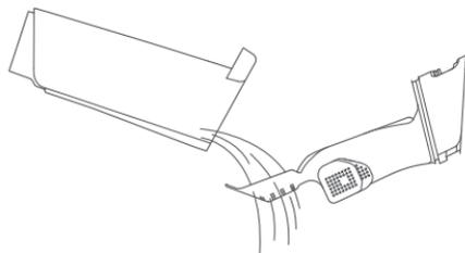
4. Réinstallez le couvercle, inclinez le réservoir d'eau sale, mettez en place sa partie inférieure, puis poussez-le doucement vers l'intérieur pour qu'il s'enclenche.
