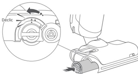
7. Afin d'installer les rouleaux avant, marqués en rouge et bleu, sur les côtés adaptés de la tête, pincez-les avec les deux mains et alignez-les avec l'axe du rouleau avant. Poussez-les vers l'intérieur pour les installer correctement.
