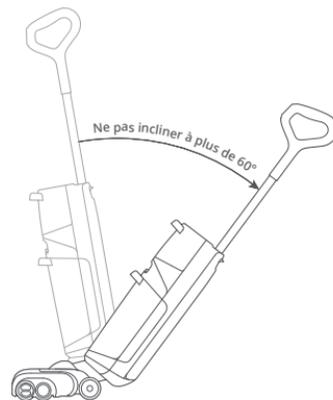
**Attention :** afin d'éviter que de l'eau sale ne s'écoule, ne posez pas le châssis à plat et ne l'inclinez pas à un angle supérieur à 60° lorsque le réservoir d'eau sale est installé.
